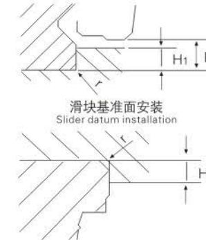
将滑块和导轨安装在床身和工作台时,为使滑块和导轨不与基础发生干涉,按表-10中的R值加工成清角槽。
